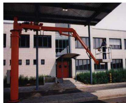
**Standgelenkteleskopbühne für die Überprüfung von LKW Ladungen in Entsorgungsbetrieben**
