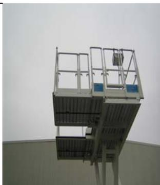
Scherenshubarbeitsbühne für Fahrwerks-, Triebwerks- und Tragflächenwartungen
