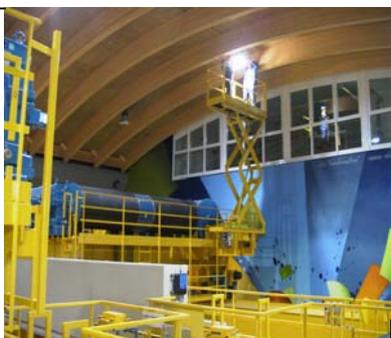
**Scherenbühne als Kranlagenaufsatz für Deckenwartungen**
