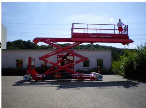
Nach Atex Richtlinien explosionsgeschützte Scherenshubarbeitsbühne mit Mecanum Rädern, Kontaktleisten rings um die Plattform und einer in zwei Richtungen möglichen Plattformverschiebung (längs & quer) zum Einsatz bei Lackierarbeiten an Flugzeugen
