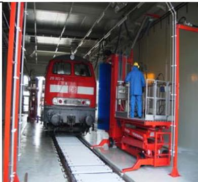
**Selbstfahrende Scherenhubarbeitsbühne als Waschanlage zur Reinigung von Lokomotiven**
