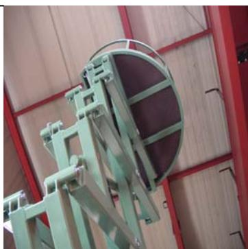
Scherenshubarbeitsbühne mit runder Plattform für Konstruktion der Ariane Rakete
